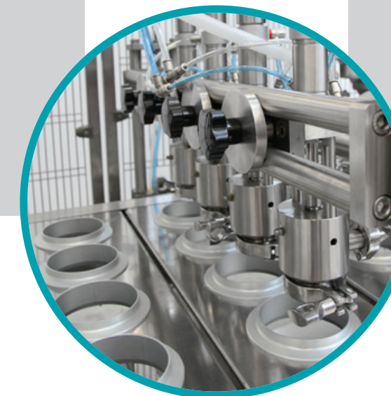
Stazione topping / Topping station
